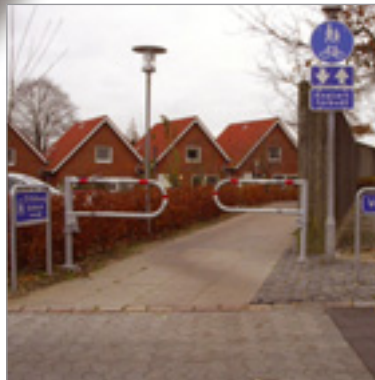
BG beskytter ved udkørsel, når et sæt er opstillet forskudt på en gang- og cykelsti
